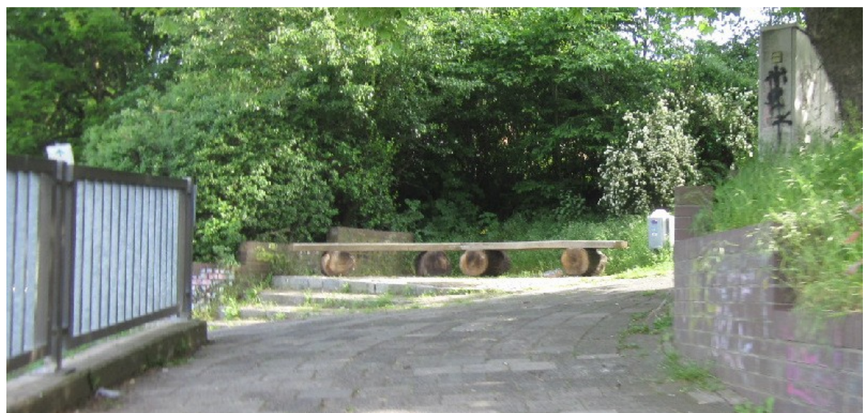
Bild 21: Nicht einsehbare Einmündung von rechts: Entschärfung oder Verkehrsspiegel notwendig.
